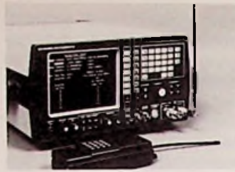
Bild 1: Meßplatz für alle Funkgeräte (Marconi-Pressbild)
