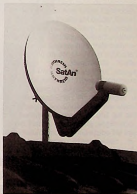
Bild 3: Die Offset-Parabolspiegelantenne AS 60, deutlich ist das „offset“ angebrachte Erregersystem erkennbar
